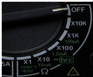
ภาพที่ 1.3 การตั้งย่านการวัดที่ \times 1
