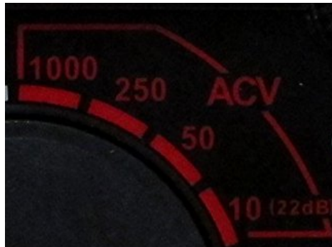
ภาพที่ 1.10 การตั้งย่าน AC 1000 V ของมิเตอร์
