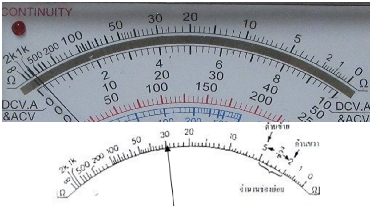
ภาพที่ 1.5 สเกลวัดความต้านทานบนหน้าปัทม์
