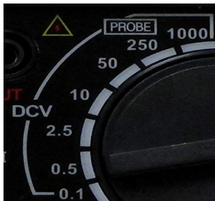
ภาพที่ 1.6 การตั้งย่าน DC 1000V ของมิเตอร์
